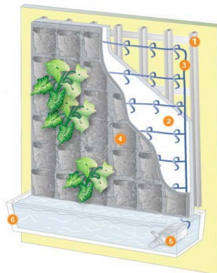
Рис. 1. Схема обустройства войлочных каркасов и используемых материалов [3]:
