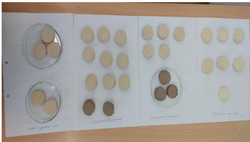
Рис. 2. Внешний вид сухих отливок целлюлозы
