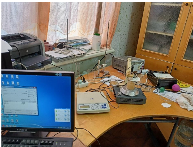
Рис. 1. Экспериментальная установка для кулонометрического определения хлорного числа
